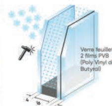
Vitrage 4 ITR/16 argon/44.2 Verre sécurisé coefficient Ug 1.1
