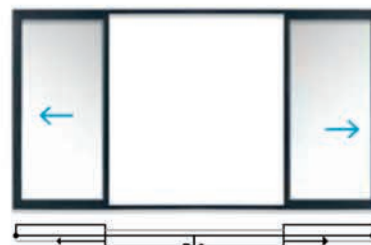
4 vantaux - 2 rails Largeur jusqu'à 6,20 m
