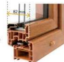
Renforcement sur ouvrant avec fibres tressées en continu et dormant avec un renfort acier (suivant abaque pour le blanc, beige et gris et systématique pour l'aspect bois). Apporte rigidité et tenue dans le temps sans aucun dérèglement des ouvrants.
