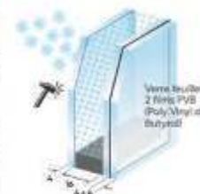
Vitrage 4 ITR/16 argon/44.2 Verre sécurité coefficient Ug 1.1
